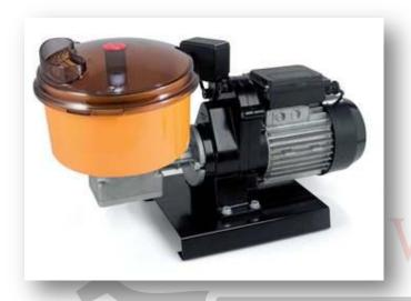
L'olio utilizzato è di tipo "Long Life" ed è idoneo al contatto accidentale con gli alimenti; non necessita di rabbocchi o sostituzione. Produttività: 1,6 kg in 3 minuti. Adatte a tutti i tipi di impasto, tra cui pasta, pane, pizza, dolci. Interruttore di sicurezza per impedire il funzionamento dell'albero a coperchio aperto. Recipiente e coperchio in policarbonato e nylon ad alta resistenza, facilmente smontabile per la pulizia. Lavabile in lavastoviglie. Albero
