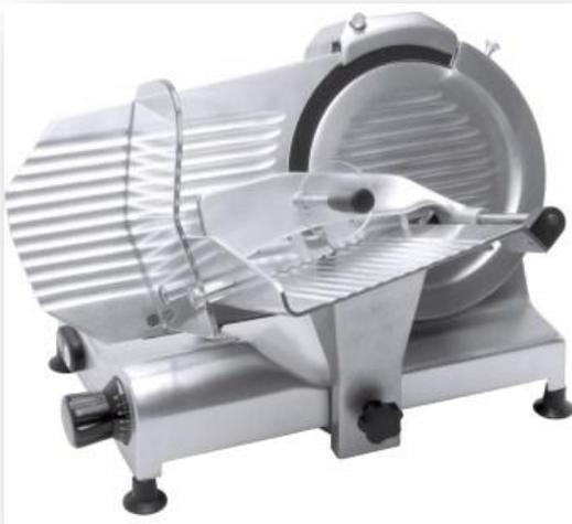
Carrello di precisione con eccezionali caratteristiche di scorrevolezza, premisalumi con puntine in acciaio INOX. Lama in acciaio INOX. Motori ad induzione a funzionamento continuo, con trasmissione a cinghia. Apparecchi professionali realizzati in fusione di alluminio, lucidati e anodizzati.
