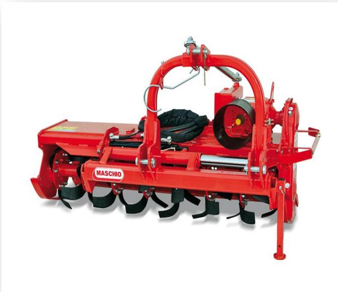
Zappatrice utilizzata principalmente su vigneti e frutteti e più in generale su tutte le colture che richiedono una lavorazione del terreno sulla fila, con spostamento manuale o idraulico. L'operatore comanda direttamente dalla trattore lo spostamento della macchina mediante il dispositivo idraulico. Disponibile nella versione centrale e media, nelle misure da 1,60 a 2,05 m, per trattori da 40 a 80 HP, è fornita con riduttore semplice o cambio con P.d.p. 540 giri/min.
