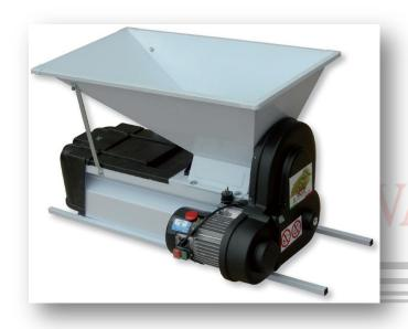
La nostra pigiadiraspatrice, dal disegno semplice e moderno, garantisce la massima affidabilità per la qualità dei materiali e per la tecnologia e la cura con cui è costruita. La pigiatura morbida dell'uva avviene tramite due rulli in nylon e poi successivamente c'è la separazione dell'acino dal raspo tramite l'albero di diraspatura e la griglia estraibile in acciaio inox. E' disponibile nelle versioni manuali o a motore elettrico; verniciate, inox o combinate verniciate ed inox. E' possibile
